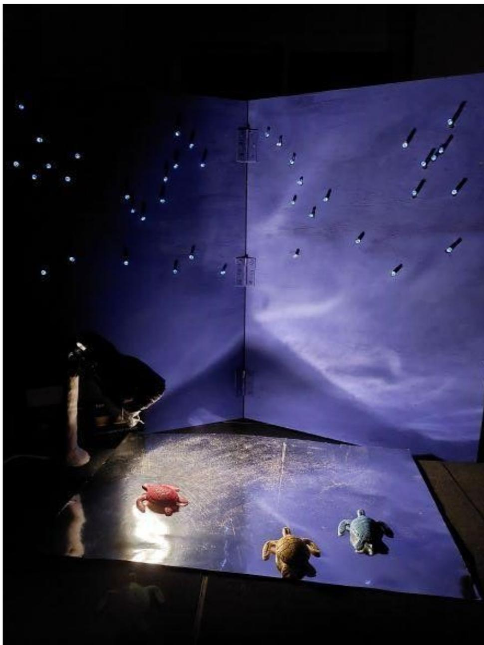
Figure 5: Il modello in buone condizioni di illuminazione ma con la presenza di un suolo riflettente.
