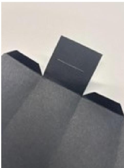
Figure 4: Fenditura sul cartone dello spettroscopio.
